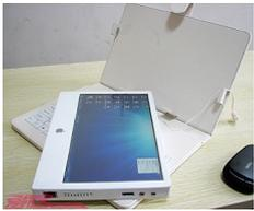
При изготовлении использовались следующие комплектующие: ноутбучная материнская плата с процессором Intel Atom N270 и встроенным 3G модемом, 1ГБ SO-DIMM DDR, жесткий диск 2.5" и сенсорный экран 10":
